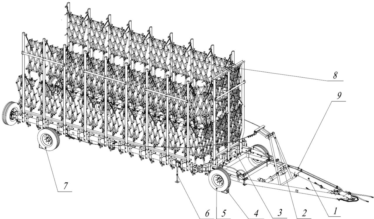
Рис.1а Борона широкозахватная гидрофицированная БШГ-21
