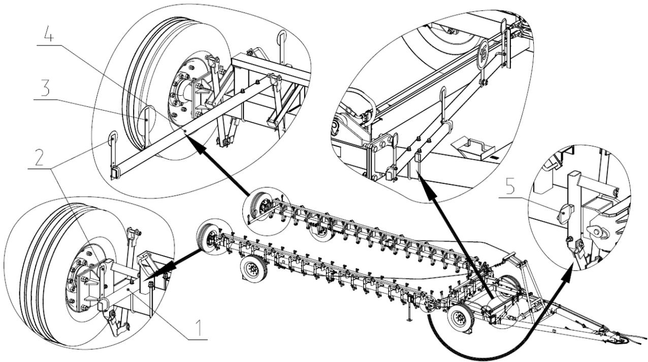
Рис.16. Борона широкозахватная гидрофицированная БШГ-21 (подготовленная для дальнего транспорта)
