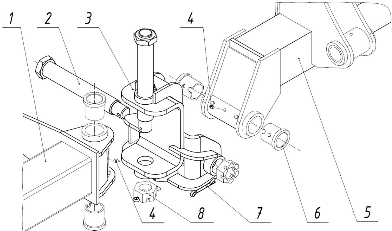
Рис.5 Шарнирное соединение балок
