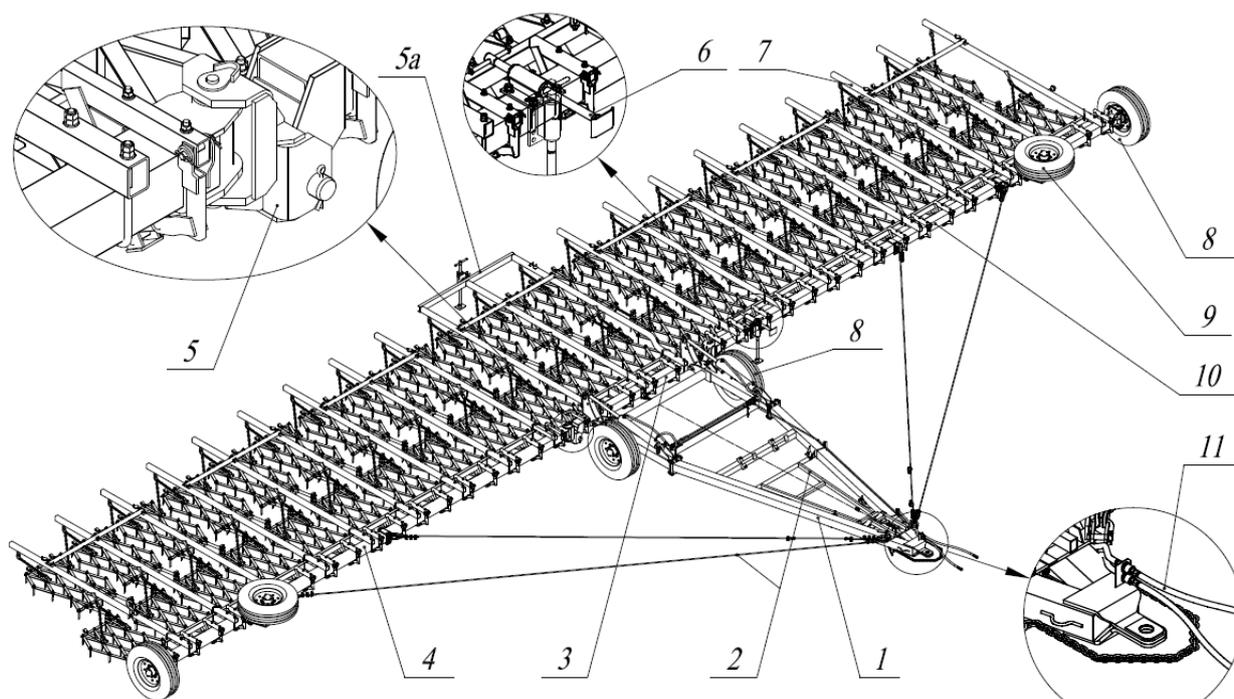
Рис.1 Борона широкозахватная гидрофицированная БШГ-21 с комплектом борон БЗСС-1,0.
