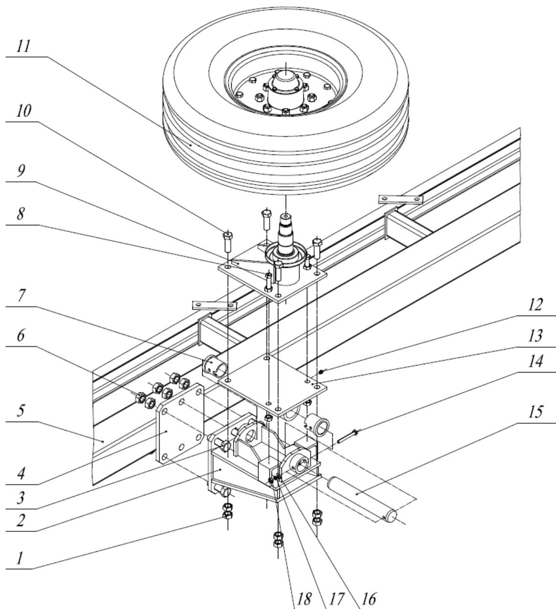
Рис.7а Установка колеса СГВ 03.010-01
