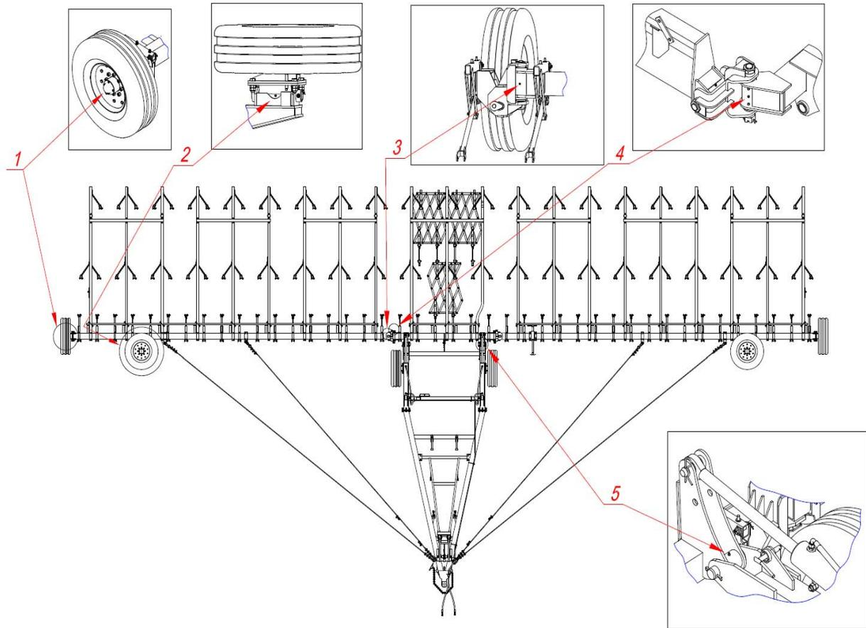
Рис.18 Схема смазки.
