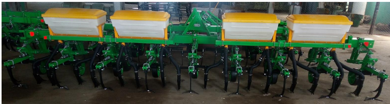
Рисунок1 (Общий вид культиватора КПМ 5.6 с системой высева гранулированных удобрений)
