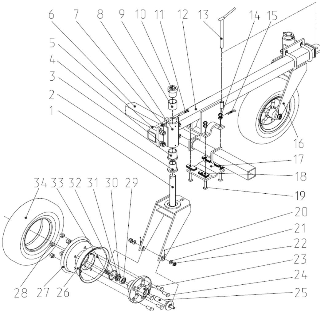
Рис.9 Блок боковых колес в сборе (правый)
