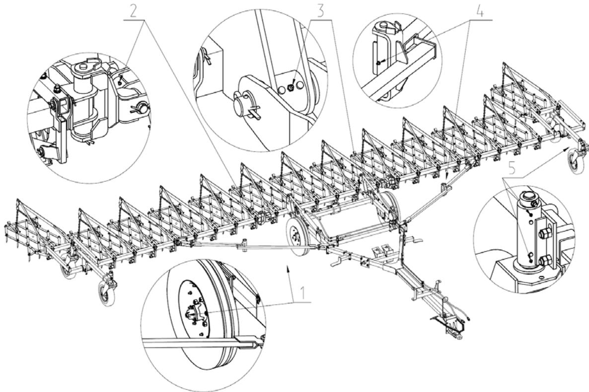
Рис.14 Схема смазки
