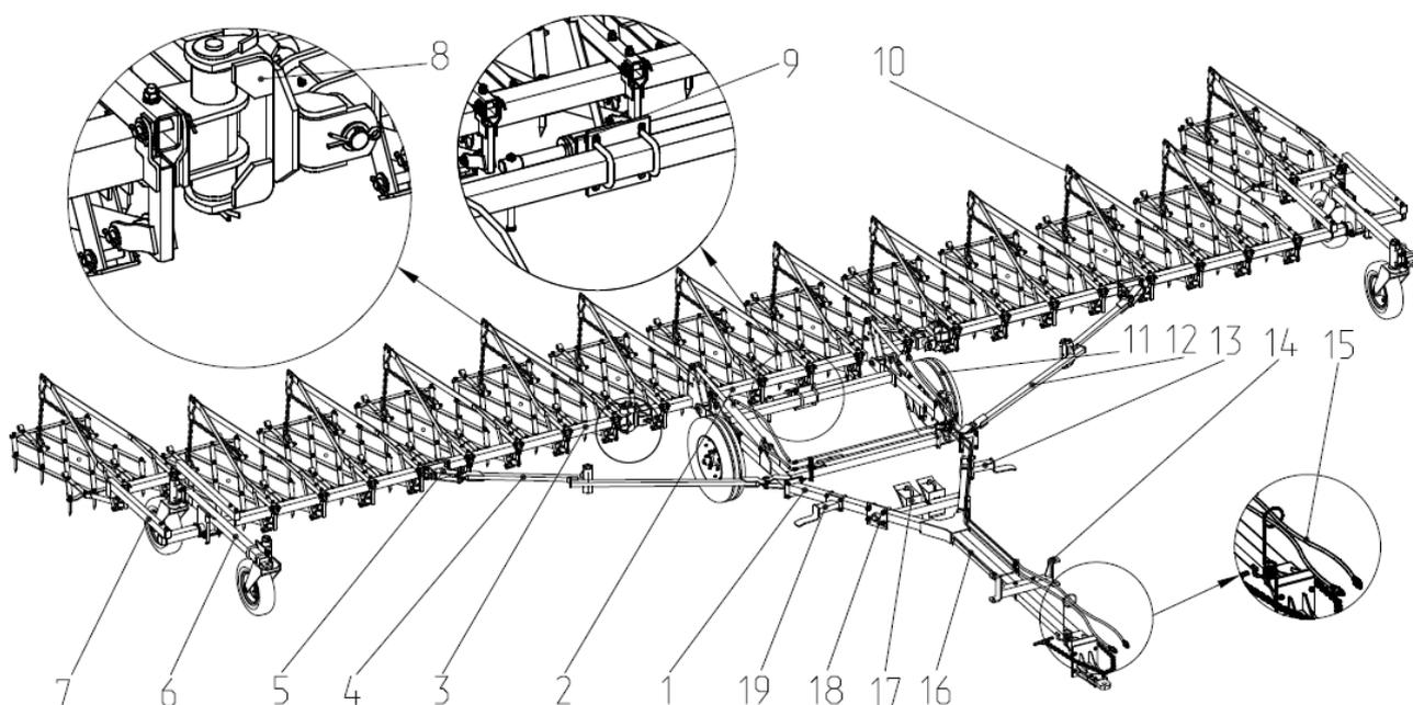
Рис.1 Борона гидрофицированная БШ-12 с комплектом боронок БЗСС-1,0
