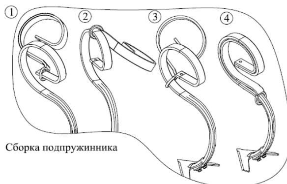
Рис. 10.2 Стойка пружинная в сборе.
