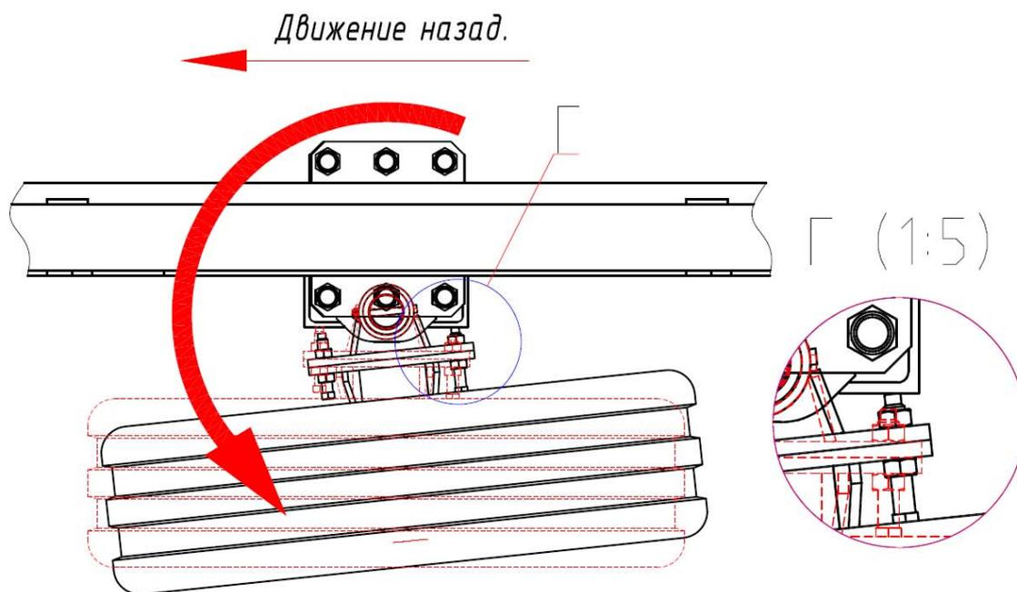
Рис.16 Регулировка транспортных колес боковых балок
