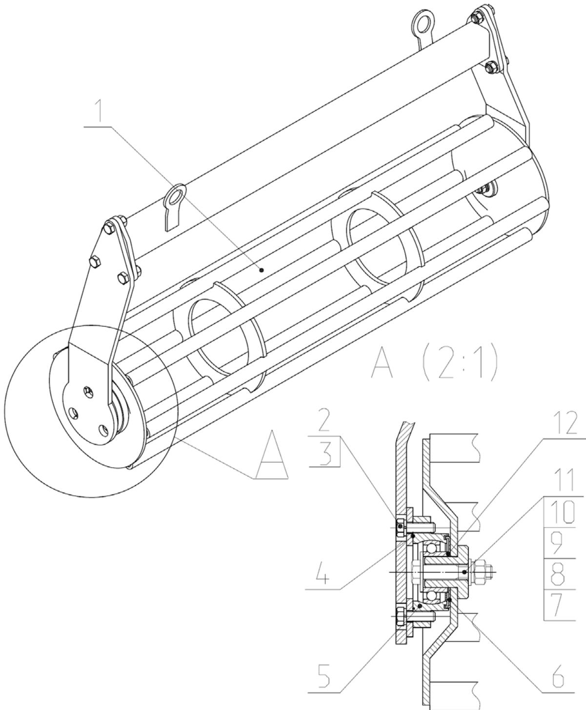
Рис.11.3 Установка корпуса подшипника в катках.
