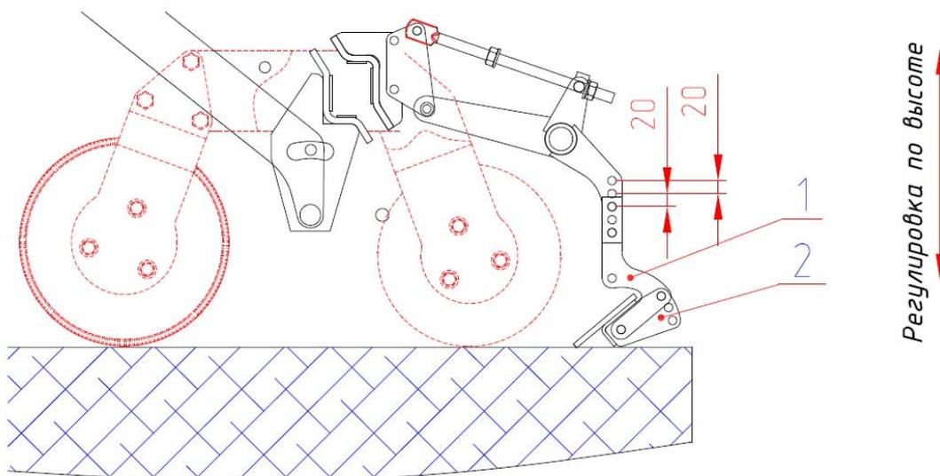
Рис.15.3 Регулировка планчатого выравнителя по высоте.
