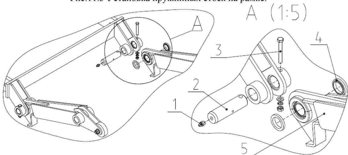
Рис.11.6 Установка поводков на рамке.
