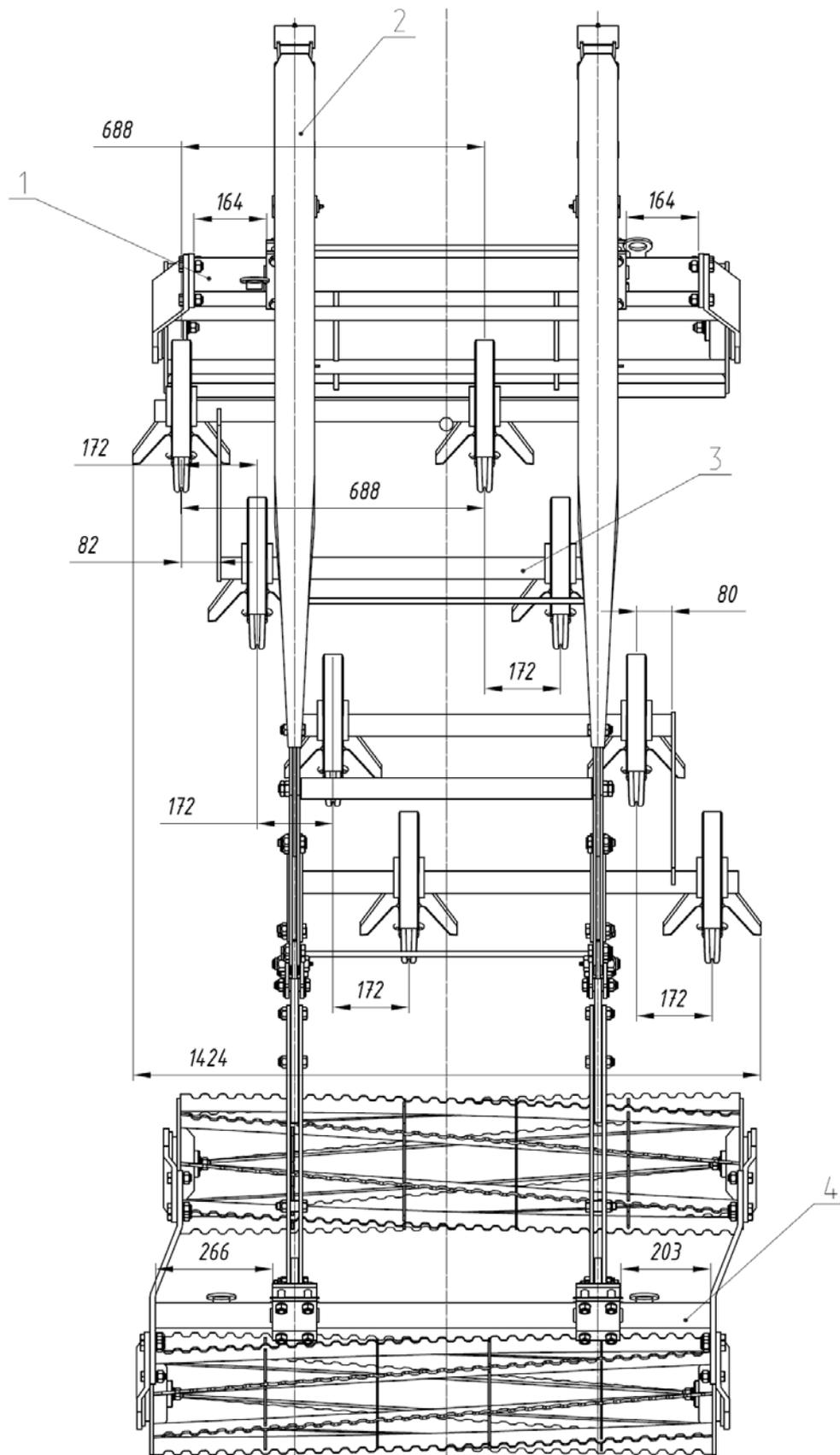
Рис.11.1 Секция рабочих органов КБП 02.000-04 (расположение рабочих органов).
