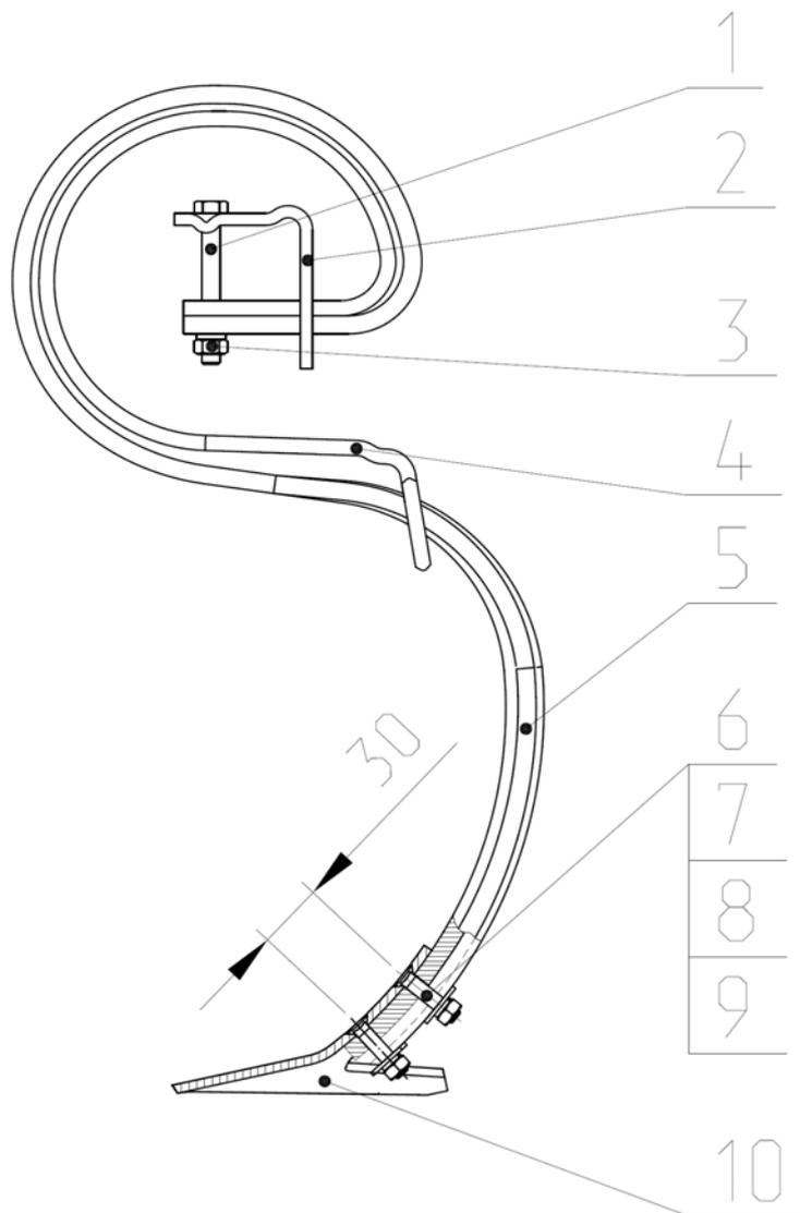
Рис. 11.2а Стойка пружинная в сборе.
