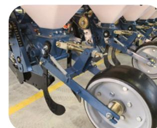
Низко расположенный высевающий аппарат и короткий трубопровод обеспечивает точное расположение семян
