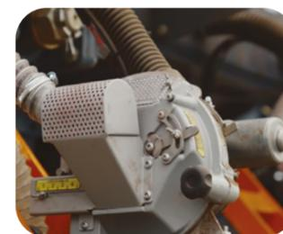
Высевающие аппараты Geronzi обеспечивающие высокую сингуляцию, идеальную точность расстановки семян. Надежность и высокая адаптивность к широчайшему спектру семян различных культур
