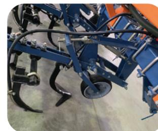
Рабочая глубина настраивается с помощью винта с метрической резьбой на каждой секции культиватора
