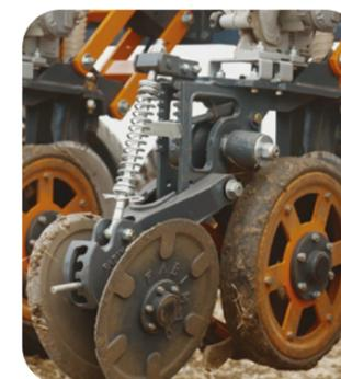
Сошники работают с давлением до 400 кг, обеспечивая плавность хода и равномерное появление всходов даже в твердых почвах. Сошник можно использовать как для посева по традиционной технологии обработки почвы, так и для прямого посева
