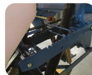
Возможность регулировки давления секции на почву (до 60 кг)
