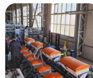
Сеялки Миллеровосел-маш перед отправкой покупателю проходят тест на испытательном стенде, где проверяется работа каждого высевающего аппарата
