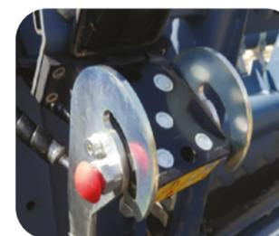
Единый гидроразъем позволяет агрегатировать жатку с комбайнами различных моделей
