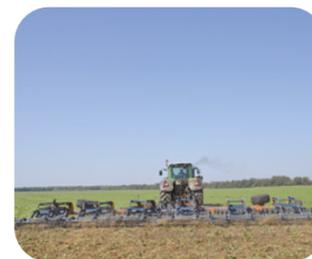
Культиватор состоит из двухметровых секций, каждая из которых является обособленным культиватором. Такая конфигурация позволяет максимально точно копировать микрорельеф поля
