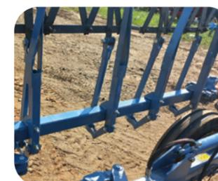
Жесткая поводковая система крепления зубов борон исключает отклонение от прямолинейного движения бороны и засакиванию борон друг на друга, обеспечивая повышение качества выполнения технологического процесса
