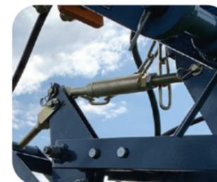
Талреп в параллелограммном механизме позволяет регулировать угол атаки рабочих органов
