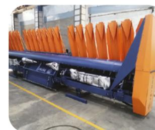
Новая модификация стеблеподъемников позволяет более компактно хранить жатку в межсезонье. Нет необходимости снимать стеблеподъемники при транспортировке
