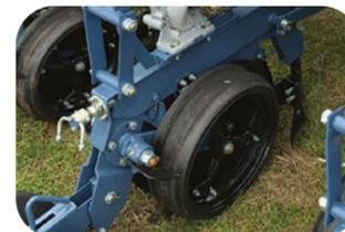
Точное удержание заданной глубины за счет регулировки опорных боковых колес
