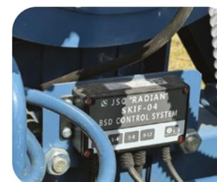
В стандартной комплектации оснащена системой контроля высева «SKIF»
