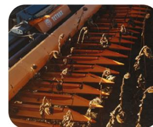
Гидравлический привод мотовила: от 0 - 100 оборотов в мин.
