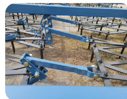
Кронштейн закрепленный на первом ряду зубовых борон обеспечивает оптимальный угол установки поводков второго ряда, исключая при этом зарывание борон второго ряда
