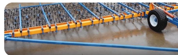
Боковые тросовые растяжки заменены на балки с дугами для усиления конструкции
