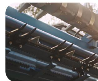
Высокоточный режущий аппарат Schumacher со сменными ножами.
