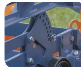
Удобная и точная регулировка глубины хода рабочих органов
