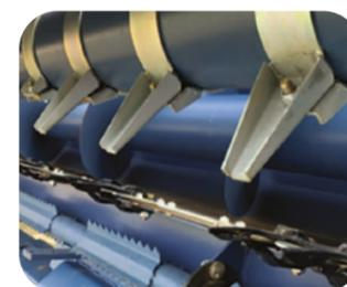
Мотовило со спиральным расположением пальцев обеспечивает равномерную подачу корзинок к шнеку
