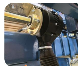
Катушечная система дозирования обеспечивает подачу точно заданной нормы удобрений, а также исключает просыпание во время остановок
