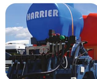
Контроль и автоматическое поддержание установленной нормы расхода жидкости независимо от скорости движения агрегата, передача данных на облачный сервер, контроль и учет расхода удобрений
