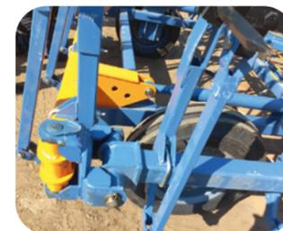
Усиленное шарнирное соединение крыльев и центральной балки
