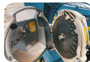
Две модификации сеялок: высевающий аппарат Geronzi или высевающий аппарат Миллервосельмаш
