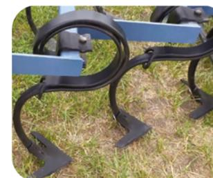
Стрельчатые лапы 220 см собственного производства из стали 65Г, с нанесением наплавленного слоя на режущую часть для повышения износостойкости и эффекта самозатачивания
