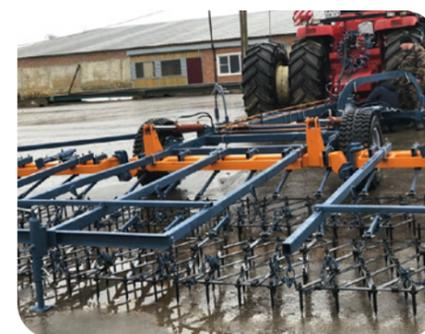
Жесткая поводковая система крепления зубовых борон исключает отклонение от прямолинейного движения бороны и засакивание борон друг на друга, обеспечивая повышение качества выполнения технологического процесса
